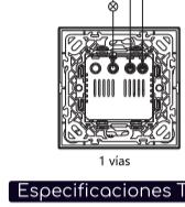
**Paso3.** Instale la parte exterior con la parte interior y atorníllelas.
